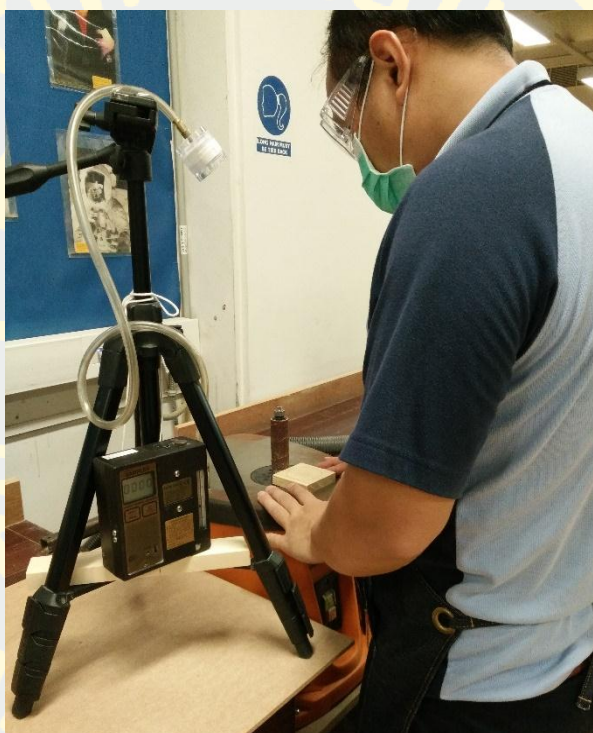
ภาพที่ 40 การทดลองเก็บตัวอย่างฝุ่นไม้ ก่อนการติดตั้งระบบกำจัดฝุ่นไม้
