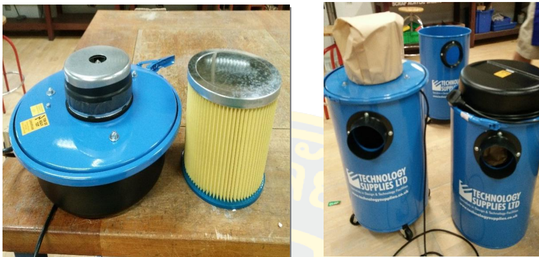
ภาพที่ 37 ลักษณะถังดักฝุ่น พัดลมมอเตอร์ไฟฟ้า ตัวกรองฝุ่น และถุงกระดาษกรอง
