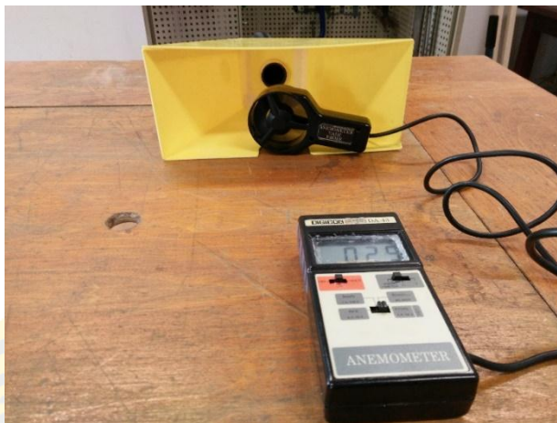
ภาพที่ 38 การทดสอบความเร็วลมบริเวณหน้าหัวคู
