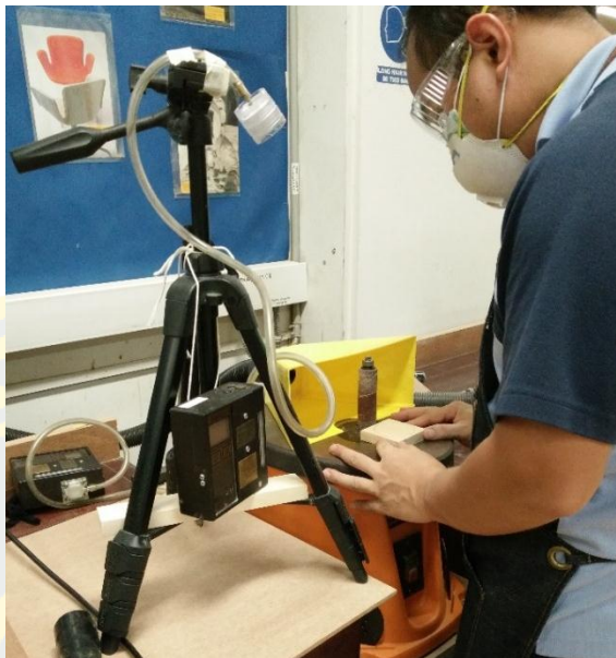
ภาพที่ 41 การทดลองเก็บตัวอย่างฝุ่นไม้ หลังการติดตั้งระบบกำจัดฝุ่นไม้
