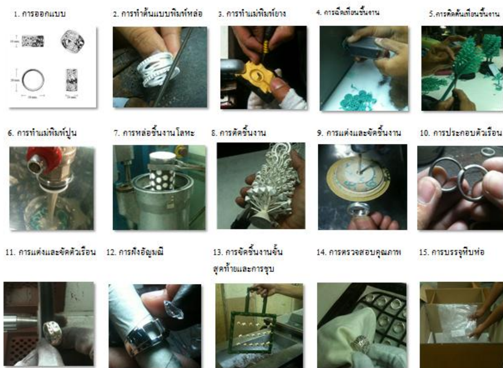
ภาพที่ 2-2 ขั้นตอนการผลิตเครื่องประดับแท้ (โดยกรรมวิธีการหล่อ)
