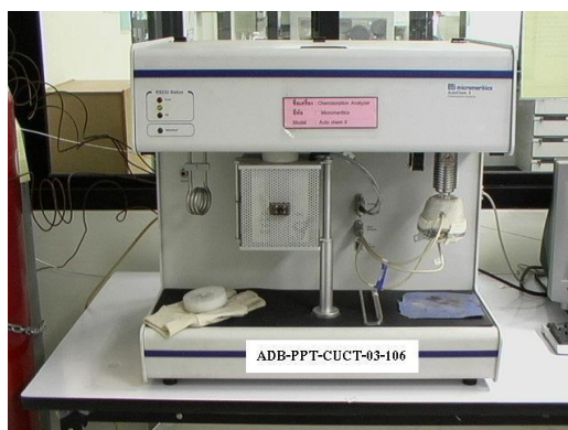
ภาพที่ 2-10 เครื่องมือทดสอบการคายซับแก๊สคาร์บอนไดออกไซด์ (Chulalongkorn University, 2017)
