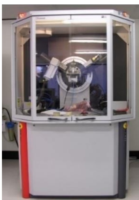
ภาพที่ 2-8 เครื่องมือวิเคราะห์โครงสร้างผลึก (Ammrf.org, 2014)
