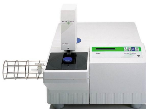
ภาพที่ 2-9 เครื่องมือวิเคราะห์การเปลี่ยนแปลงน้ำหนักทางความร้อน
