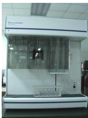
ภาพที่ 2-7 เครื่องวิเคราะห์ขนาดพื้นที่ผิวจำเพาะและปริมาตรรูพรุน (Chulalongkorn University, 2017)
