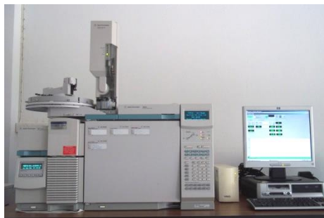
ภาพที่ 6 เครื่อง Gas Chromatograph-Mass Spectrometer (GC-MS) ของบริษัท Agilent รุ่น Agilent 6890N Gas Chromatograph/5970 inert Mass Selective Detector ปริมาณสารต่ำสุดที่สามารถวิเคราะห์ได้
