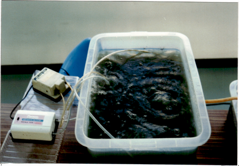
ภาพที่ 3.2 ถังปฏิบัติการของระบบบำบัดแบบชีววิทยา
