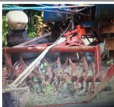
ของประดิษฐ์เครื่องมือใช้ขั้นที่ 2 ลูกปัก ใช้แทนการไถ การขุด และการคราด
