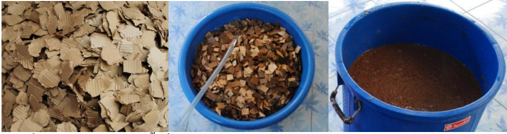
ภาพที่ 3-3 ภาพการเตรียมน้ำเยื่อกระดาษลัง (ผู้วิจัย,2559)
