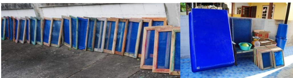
ภาพที่ 3-11 ภาพการทำความสะอาดตะแกรง (ผู้วิจัย,2559)
