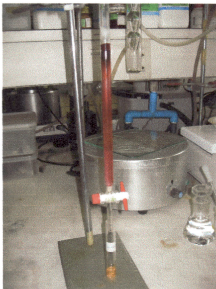
ภาพที่ 4 การทำ fractionation ด้วย column chromatography ของแอสติโนมายซีที 54-4
