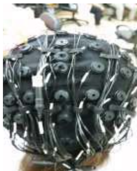
ภาพที่ 3-12 การใส่หมวกอิเล็กโทรดและใส่น้ำยาลีอิเล็กโทรไลต์
