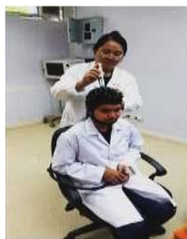
ภาพที่ 3-12 การใส่หมวกอิเล็กโทรดและใส่น้ำยาลีอิเล็กโทรไลต์
