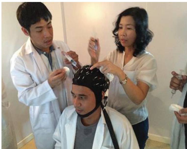
ภาพที่ 3-11 การบรรจุน้ำเกลือ (Electrolyte) เพื่อนำสัญญาณไฟฟ้า
