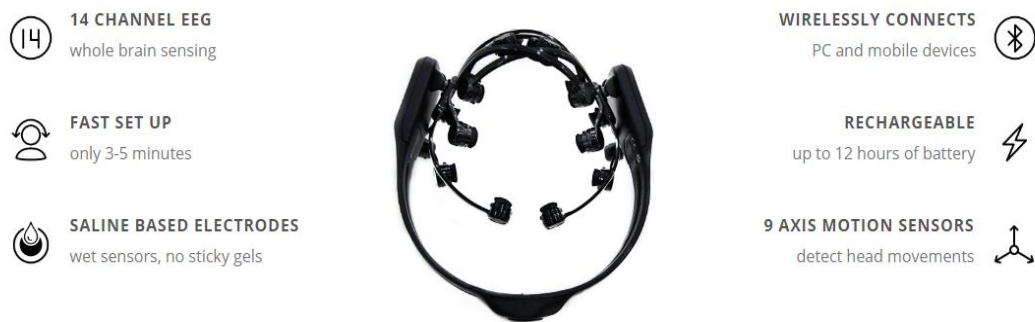
ภาพที่ 2-17 คุณสมบัติของเครื่องมือวัดคลื่นไฟฟ้าสมองชนิดพกพา Emotiv รุ่น Epoc ที่มา https://www.emotiv.com/epoc/
