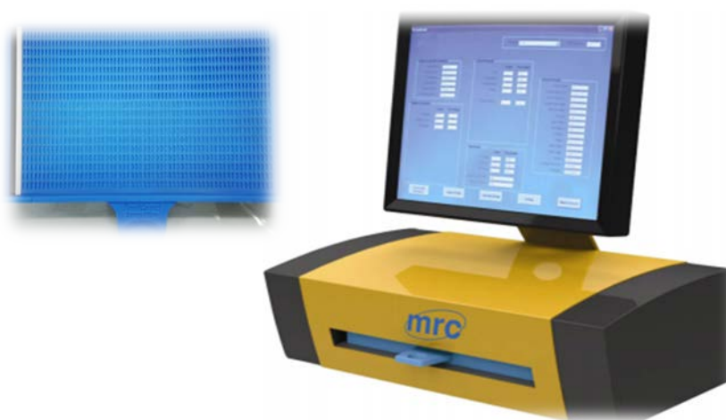
ภาพที่ 2-6 เครื่อง NIR-SC-5000-1/2(Digital Image Analysis System for Grain) ของศูนย์วิจัยข้าวปทุมธานีที่ใช้สำหรับวิเคราะห์ขนาดเมล็ดข้าว
