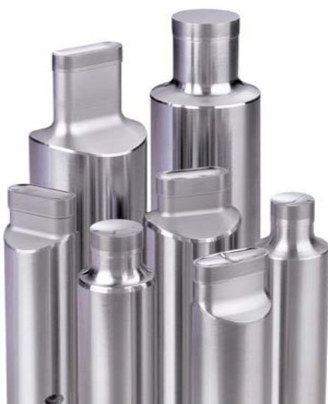
ภาพที่ 19 พันธ์คาร์ไบด์ที่มีรูปร่างลักษณะพิเศษและลูกเบี้ยวเครื่องจักรกล (Camshaft) ที่ผ่านการผลิตและเจียร์น้ยจากเครื่องจักรกลที่พัฒนาขึ้นมาจากทีมงานของบริษัท
