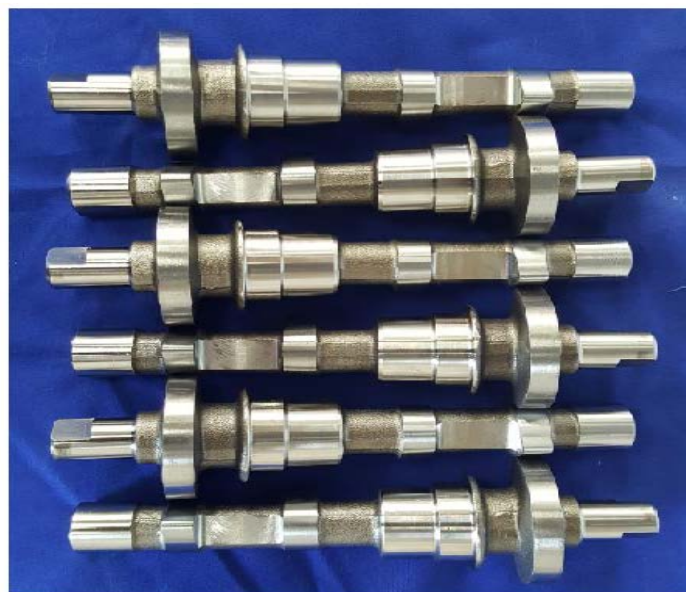
ภาพที่ 19 พันธ์คาร์ไบด์ที่มีรูปร่างลักษณะพิเศษและลูกเบี้ยวเครื่องจักรกล (Camshaft) ที่ผ่านการผลิตและเจียร์น้ยจากเครื่องจักรกลที่พัฒนาขึ้นมาจากทีมงานของบริษัท
