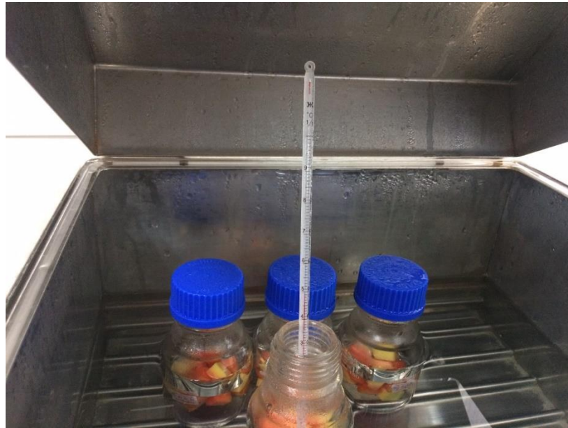
ควบคุมอุณหภูมิด้วยอ่างน้ำร้อน
