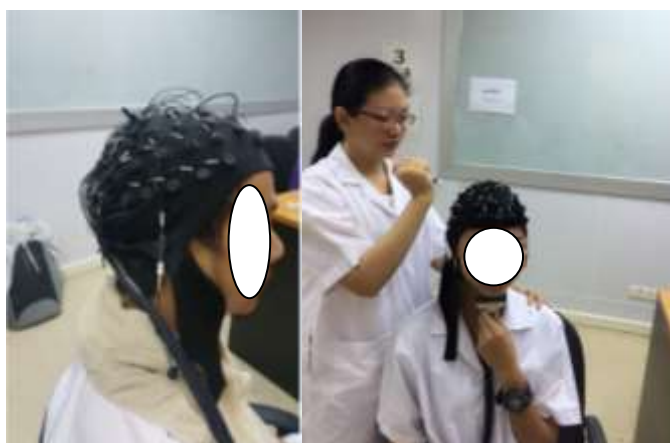
ภาพที่ 3-15 การใส่หมวกอิเล็กโทรด และใส่น้ำยาอิเล็กโทรไลต์ บริเวณแต่ละตำแหน่งของอิเล็กโทรด ทั้ง 64 ช่องสัญญาณ
