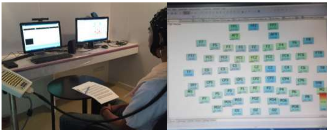
ภาพที่ 3-16 การเชื่อมต่อสัญญาณเข้ากับโปรแกรมคอมพิวเตอร์ และการตรวจสอบความต้านทานของหนังศีรษะ
