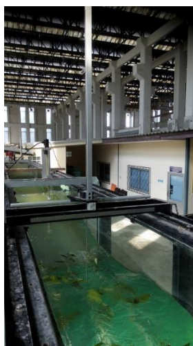
ภาพที่ 3-38 การติดตั้งเครื่องมือวัดระดับน้ำนิ่งแบบเข็มชี้และแบบวัดความสูงคลื่นแบบวัดการเก็บประจุไฟฟ้า
