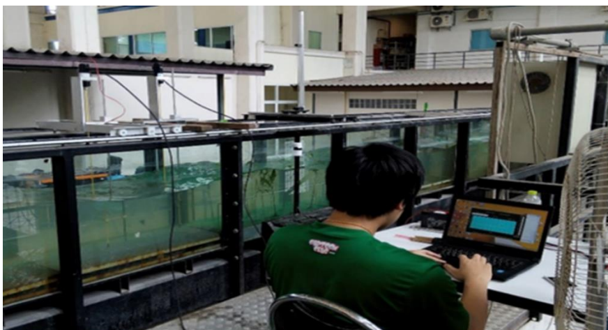
ภาพที่ 3-42 การเก็บค่าความสูงคลื่นจากเครื่องมือวัดค่าความสูงคลื่นแบบวัดการเก็บประจุไฟฟ้าด้วยคอมพิวเตอร์
