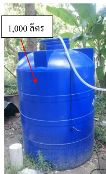
ภาพที่ 3-53 ถังเก็บน้ำกลมสำหรับการทดลองผลกระทบของระดับน้ำท่วมต้น
