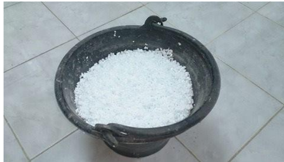
ภาพที่ 3-15 เม็ดโฟมซีเบาสำหรับผสมคอนกรีตให้มีน้ำหนักเบา
