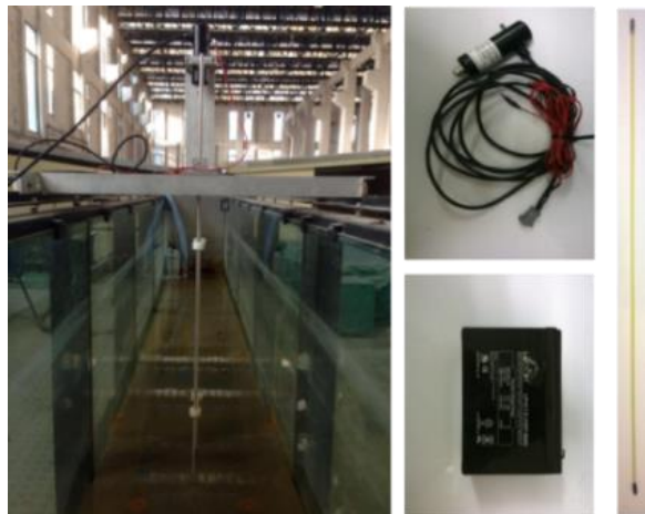
ภาพที่ 3-11 เครื่องวัดความสูงคลื่นแบบวัดการเก็บประจุไฟฟ้า
