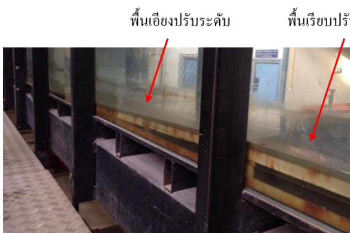
ภาพที่ 3-12 ชุดพื้นแปลงทดลองที่ประกอบไปด้วยพื้นเอียงและพื้นเรียบปรับระดับสำหรับปรับความเสถียรคลื่นก่อนเข้าสู่แปลงทดลอง
