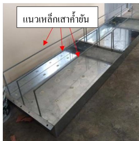
ภาพที่ 3-16 กระบะตั้งกะสีพร้อมเสาค้ำยันสำหรับใส่แปลงทดลองคอนกรีต
