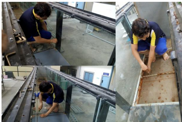
ภาพที่ 3-37 การติดตั้งชุดพื้นแปลงทดลองในรางจำลองคลื่น
