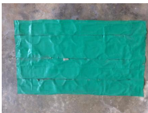
ภาพที่ 3-19 ผ้าใบสำหรับปิดผิวหน้าแปลงทดลองคอนกรีต
