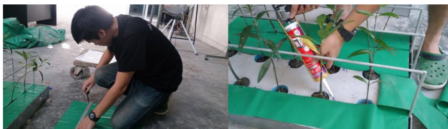
ภาพที่ 3-31 การติดแผ่นผ้าใบที่ผิวหน้าชุดแปลงทดลองคอนกรีต
