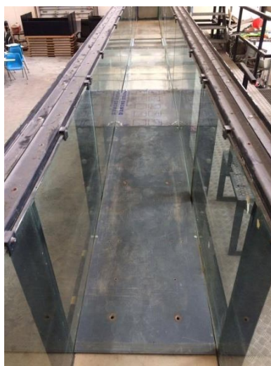
ภาพที่ 3-47 ชุดพื้นแปลงทดลองสำหรับติดตั้งในรางน้ำจำลองการไหล
