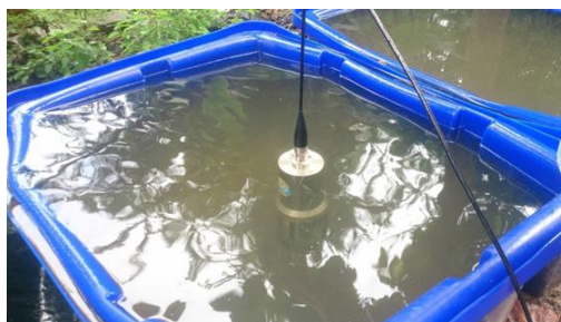
ภาพที่ 3-72 การตรวจวัดค่าความเค็มของน้ำด้วยเครื่องมือวัดคุณภาพน้ำ
