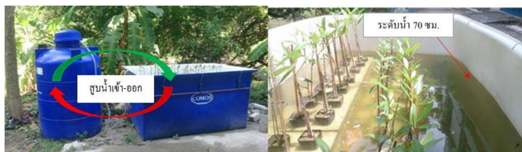
ภาพที่ 3-61 การสูบน้ำเข้ากระบะพลาสติกเพื่อจำลองการเกิดน้ำขึ้น-น้ำลง
