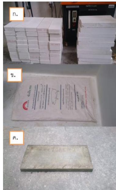
ภาพที่ 3-55 อุปกรณ์สำหรับทำระดับพื้นชั้นบันได (ก) อิฐมวลเบา (ข) ถุงทราย และ (ค) กระจาดปูพื้นอย่างหนา สำหรับทำชั้นบันได
