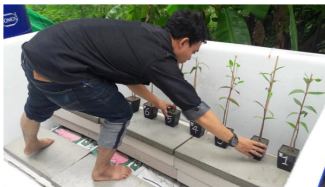
ภาพที่ 3-60 การจัดเรียงต้นกล้าป่าชายเลนในกระบะพลาสติกสำหรับการทดลองผลกระทบของระดับน้ำท่วมดิน
