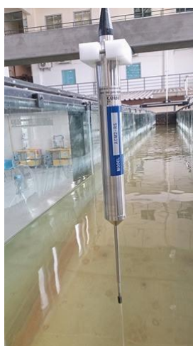
ภาพที่ 3-46 เครื่องมือวัดความเร็วกระแสน้ำ
