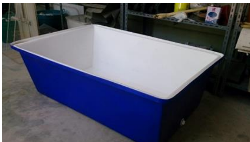
ภาพที่ 3-33 อ่างน้ำควบคุมสำหรับทดลองกรณีที่ไม่มีผลกระทบจากคลื่นและกระแสน้ำ
