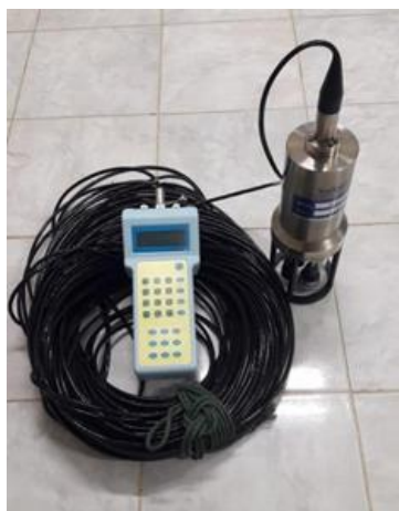
ภาพที่ 3-64 เครื่องวัดคุณภาพน้ำแบบพกพาสำหรับวัดค่าความเค็มของน้ำ
