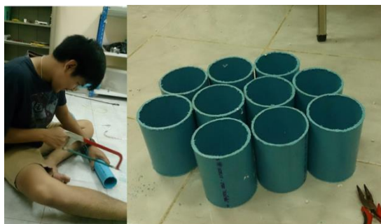
ภาพที่ 3-23 การตัดท่อพีวีซีสำหรับใช้ทำแปลงทดลองคอนกรีต
