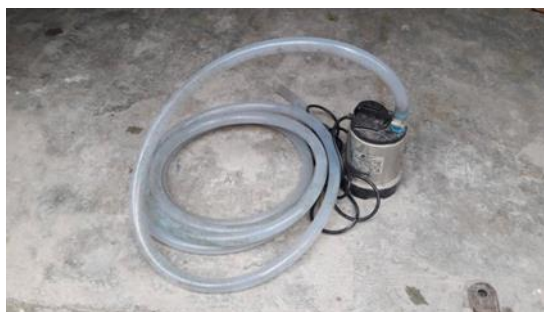
ภาพที่ 3-57 ปัมพ์จุ่มน้ำสแตนเลสสำหรับสูบน้ำจากถังเก็บน้ำเข้ากระบะพลาสติก
