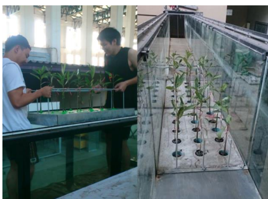
ภาพที่ 3-39 การติดตั้งชุดแปลงทดลองจำลองการปลูกต้นกล้าป่าชายเลนลงในรางจำลองคลื่น
