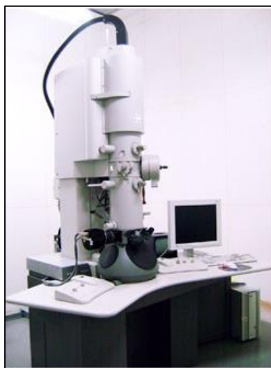
ภาพที่ 3-2 กล้องจุลทรรศน์อิเล็กตรอนแบบส่องผ่าน รุ่น TECNAI 20 บริษัท Philips
