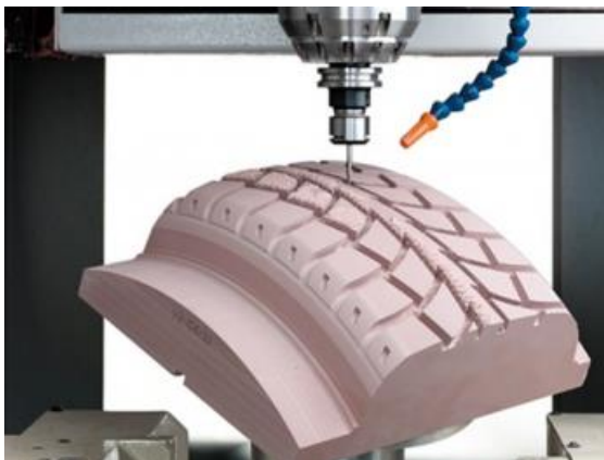
ภาพที่ 3-4 แม่พิมพ์ต้นแบบจากโพลียูรีเทน (Tien Sheng Molding Technology, 2018)
