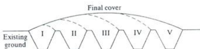
ภาพที่ 2-3 การฝังกลบแบบขุดร่อง (Trench method) (Qian et al., 2002)
