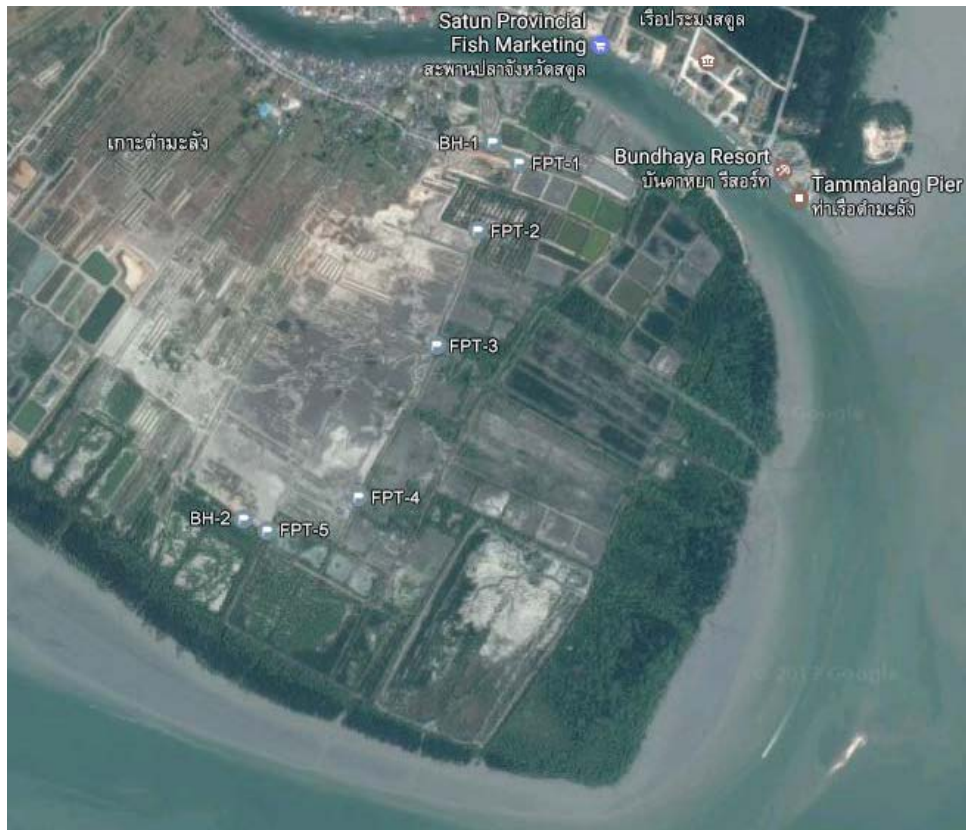
ภาพที่ 3-19 ตำแหน่งของหลุมเจาะสำรวจดิน
