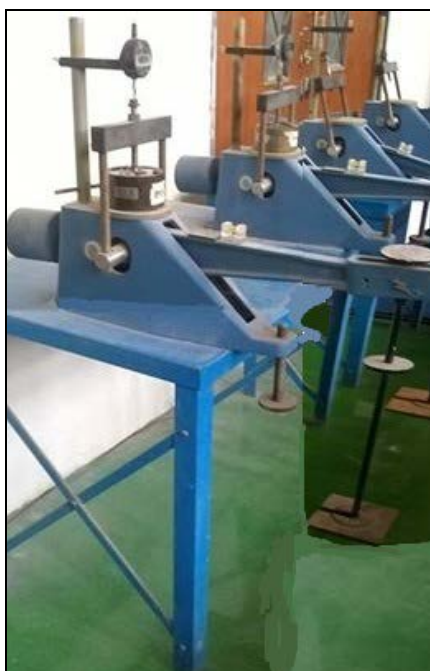
ภาพที่ 3-15 อุปกรณ์การทดสอบการอัดตัวคายน้ำ
