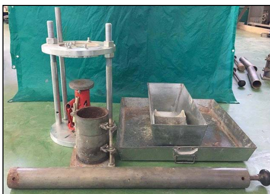
ภาพที่ 3-14 อุปกรณ์ที่ใช้ในการทดสอบการบดอัดดินแบบมาตรฐาน
