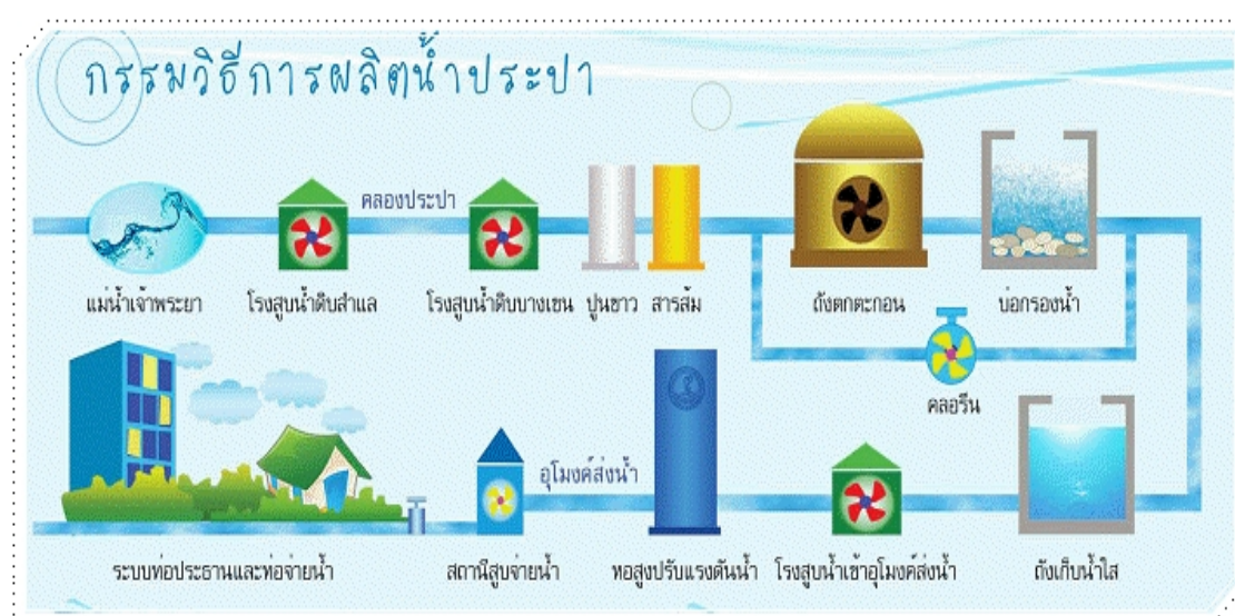
ภาพที่ 2-2 กระบวนการผลิตน้ำประปาของการประปานครหลวง (สภาวิศวกร, 2561)
