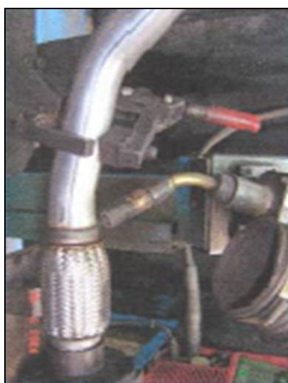
ภาพที่ 3-7 ตัวอย่างการเชื่อมงานจุดที่ 2 แบบแนวตั้ง
