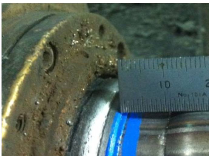
ภาพที่ 4-3 ระยะห่างของ Flex กับ Pipe หลังการปรับปรุง (11 มิลลิเมตร)
