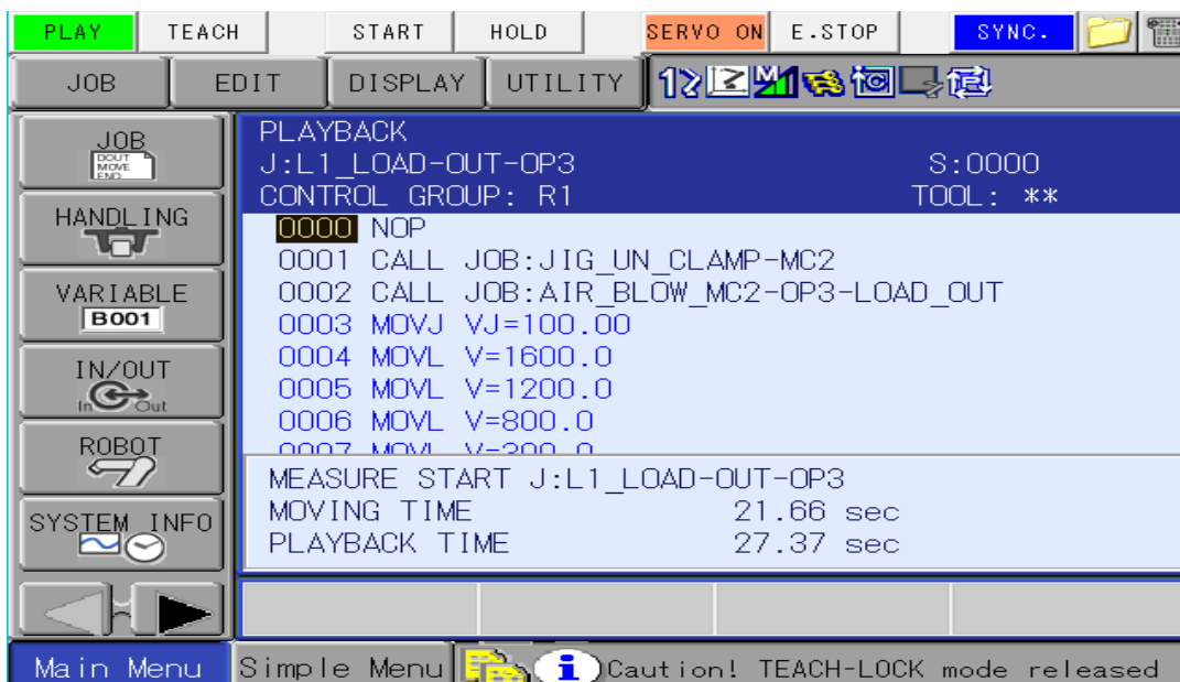
ภาพภาคผนวก ค-5 เวลาหุ่นยนต์ทำงาน นำชิ้นงานออกจากเครื่องจักร MC-2 OP-3
