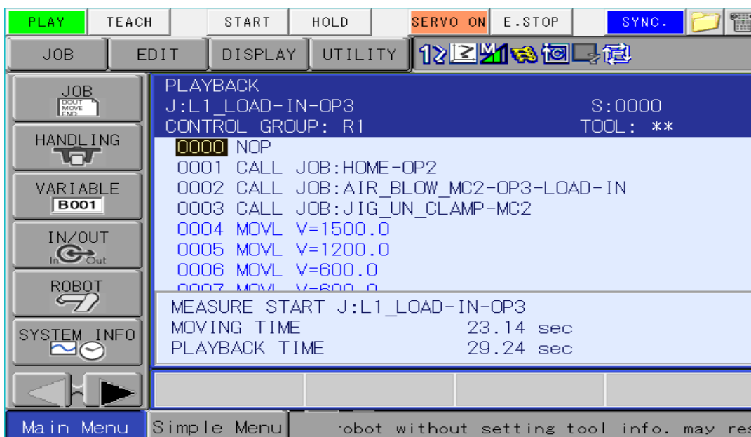
ภาพภาคผนวก ค-6 เวลาหุ่นยนต์ทำงาน นำชิ้นงานเข้าจากเครื่องจักร MC-2 OP-3
