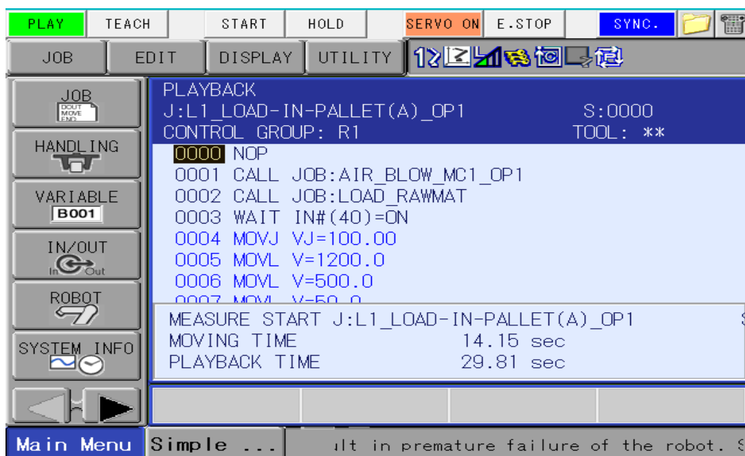
ภาพภาคผนวก ค-2 เวลาหุ่นยนต์ทำงาน นำชิ้นงานเข้าจากเครื่องจักร MC-1 OP- 1
