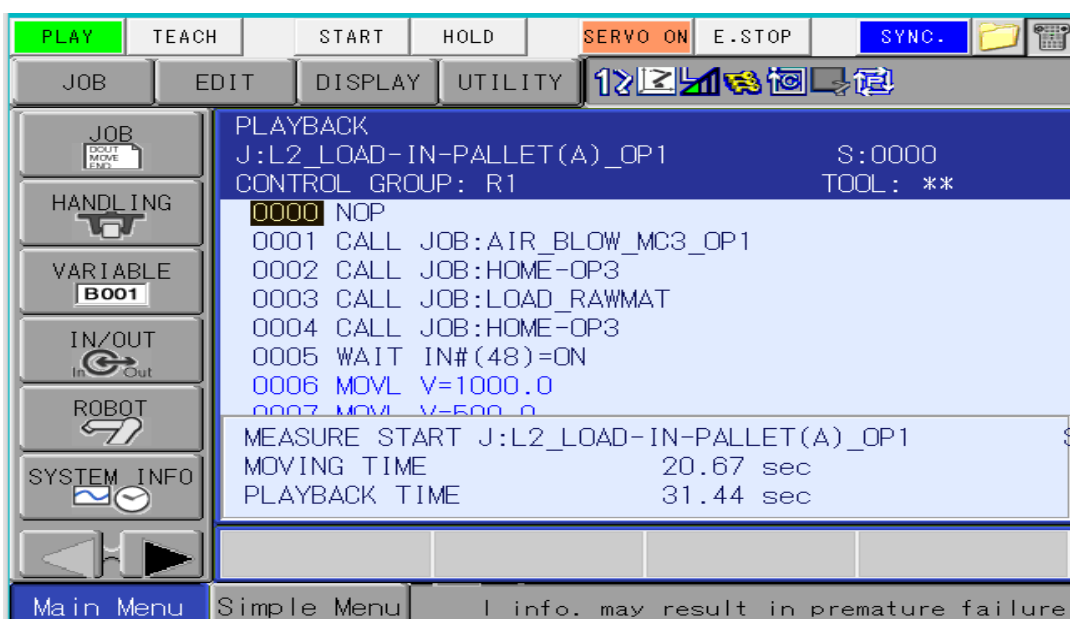
ภาพภาคผนวก ค-8 เวลาหุ่นยนต์ทำงาน นำชิ้นงานเข้าจากเครื่องจักร MC-3 OP- 1
