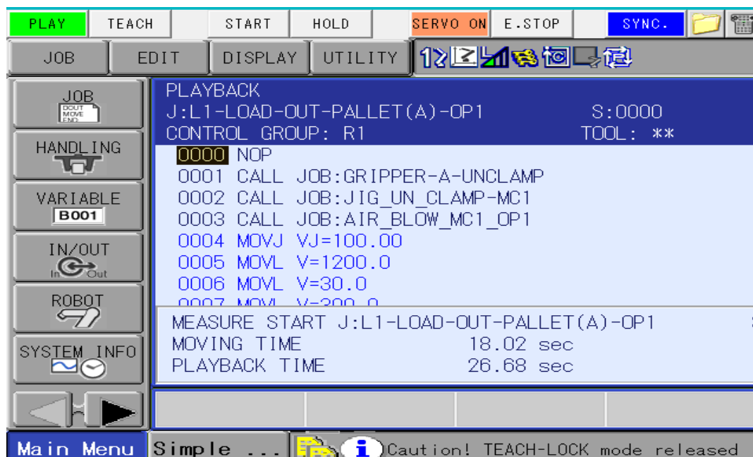
ภาพภาคผนวก ค-1 เวลาหุ่นยนต์ทำงาน นำชิ้นงานออกจากเครื่องจักร MC-1 OP- 1
