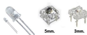
ภาพที่ 2-5 หลอด LED ชนิด Lamp type ในรูปแบบต่าง ๆ
