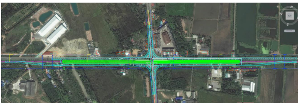
ภาพที่ 5-3 รูปแบบแปลนของทางแยกและใช้ระบบสัญญาณไฟจราจร (แบบลดเฟส)
