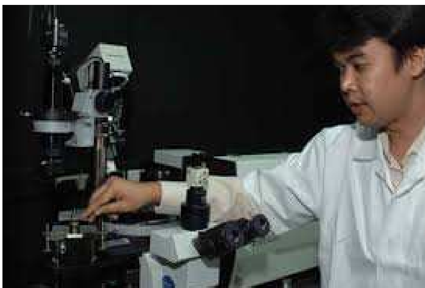
ภาพที่ 3-6 เครื่องรามันสเปกโตรสโกปี (Raman Spectroscopy) จากศูนย์นาโนเทคโนโลยีแห่งชาติ ( http://www.manager.co.th/Science/ViewNews.aspx?NewsID=9500000124432 )
