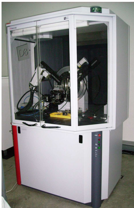
ภาพที่ 3-3 เครื่อง X-Ray Diffractometer (XRD KMUTT) จากคณะพลังงานสิ่งแวดล้อมและวัสดุ มหาวิทยาลัยเทคโนโลยีพระจอมเกล้าธนบุรี
