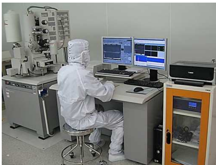
ภาพที่ 3-4 เครื่อง Field Emission Scanning Electron Microscope : FE-SEM และเครื่อง Energy Dispersive X-ray Spectroscopy (EDX) จากศูนย์เทคโนโลยีอิเล็กทรอนิกส์และคอมพิวเตอร์แห่งชาติ (ที่มา : http://tmecl.nectec.or.th/services/detail/id/e319fb147f550d8b9e473deecb3884db/lang/th )
