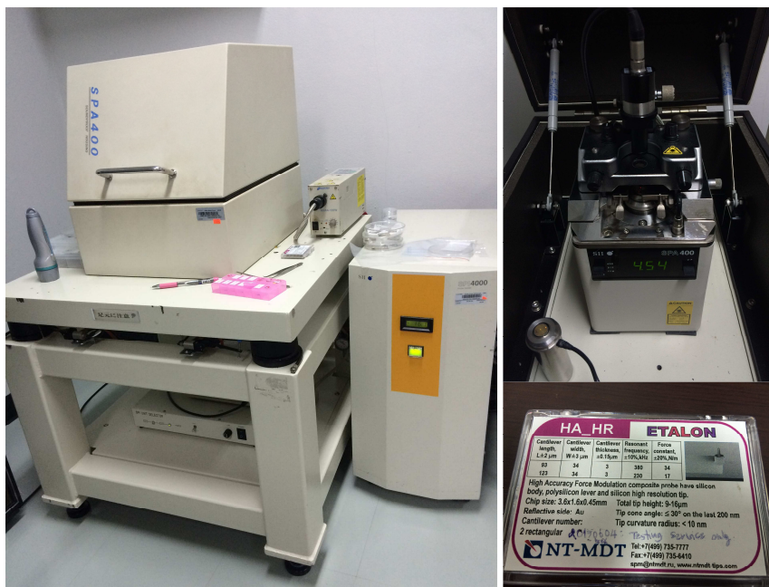
ภาพที่ 3-5 เครื่อง Atomic Force Microscope (AFM) จากศูนย์นาโนเทคโนโลยีแห่งชาติ
