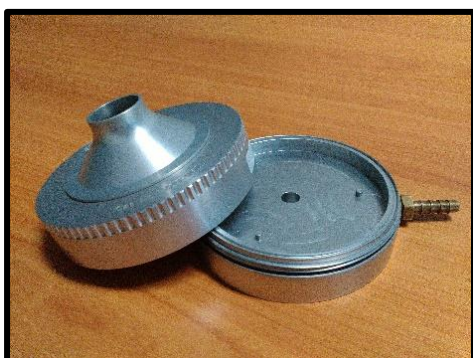
ภาพที่ 3-1 อุปกรณ์เก็บตัวอย่างเชื้อราในอากาศ Andersen single stage sampler และปุ่มดูดอากาศ
