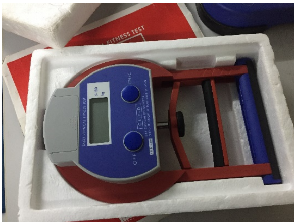
ภาพภาคผนวก ก-1 เครื่องวัดแรงบีบมือ Hand grip dynamometer (TKK 38300, ญี่ปุ่น)
