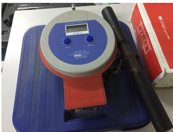
ภาพภาคผนวก ก-2 เครื่องวัดแรงเหยียดขา Back & leg dynamometer (TKK, ญี่ปุ่น)
