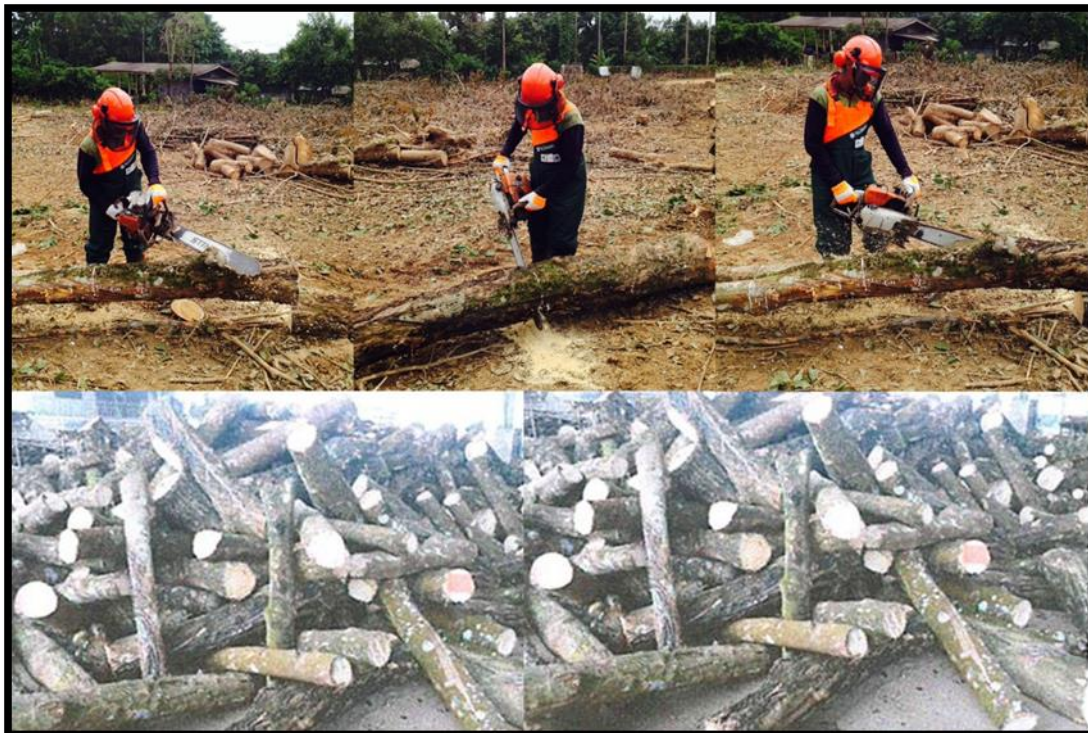
ภาพที่ 2-6 ภาพแสดงการตัดไม้ยางพาราเป็นไม้ท่อน
