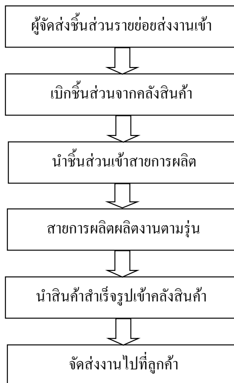
ภาพที่ 3-4 การไหลของกระบวนการผลิตในโรงงาน
