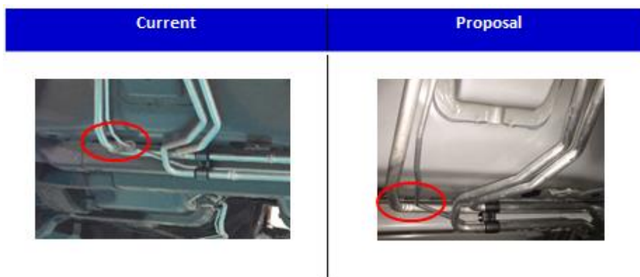
ภาพที่ 4-2 ดำเนินการทดลองแนวความคิด Rear auxiliary AC and heater line joint block: remove join block
