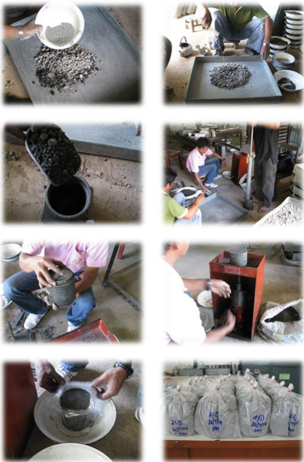
ภาพที่ 3-12 การทำแท่งตัวอย่าง Unconfined
