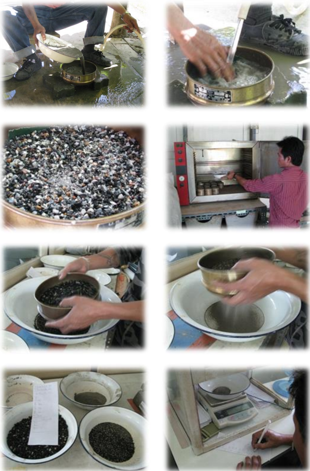
ภาพที่ 3-10 การทดลองหาขนาดเม็ดของวัสดุส่วนผ่านตะแกรง # 4
