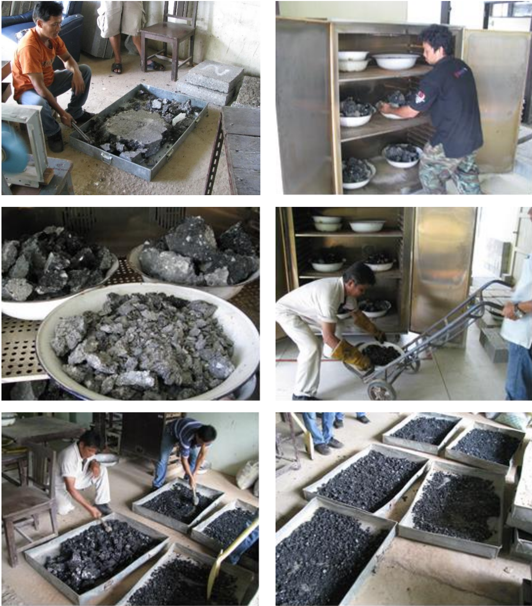
ภาพที่ 3-7 การย่อยแผ่นผิวทางเดิมแอสฟัลต์ที่ได้จากการเก็บตัวอย่างโดยวิธี SAW
