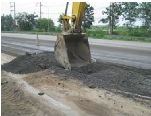
ภาพที่ 3-5 การเก็บตัวอย่างวัสดุโดยวิธีใช้กากผิว
