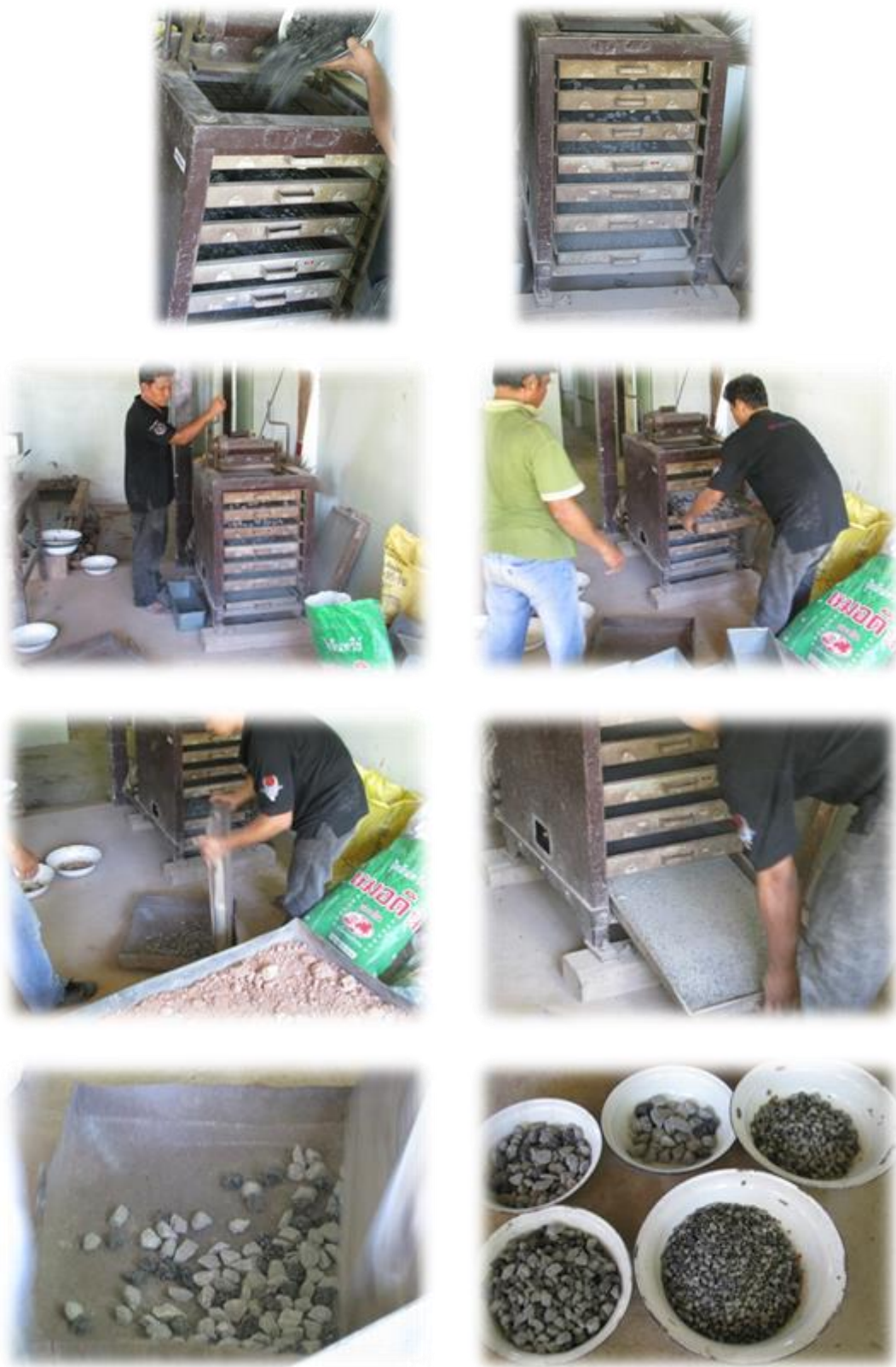
ภาพที่ 3-9 การทดลองหาขนาดเม็ดของวัสดุส่วนข้างตะแกรง # 4
