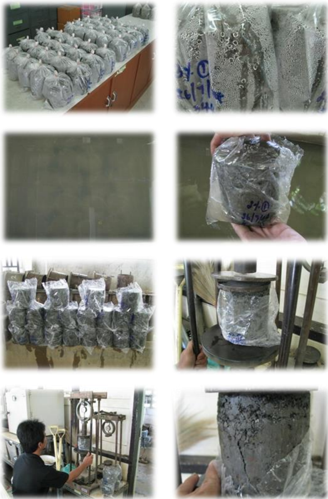
ภาพที่ 3-13 การทดสอบค่ากำลังรับแรงอัด Unconfined compressive strength ของแท่งตัวอย่าง
