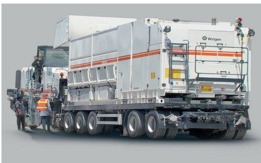
ภาพที่ 1-1 ตัวอย่างรถส่งจ่ายซีเมนต์และน้ำ (Wirtgen Co., Ltd., 2012)
