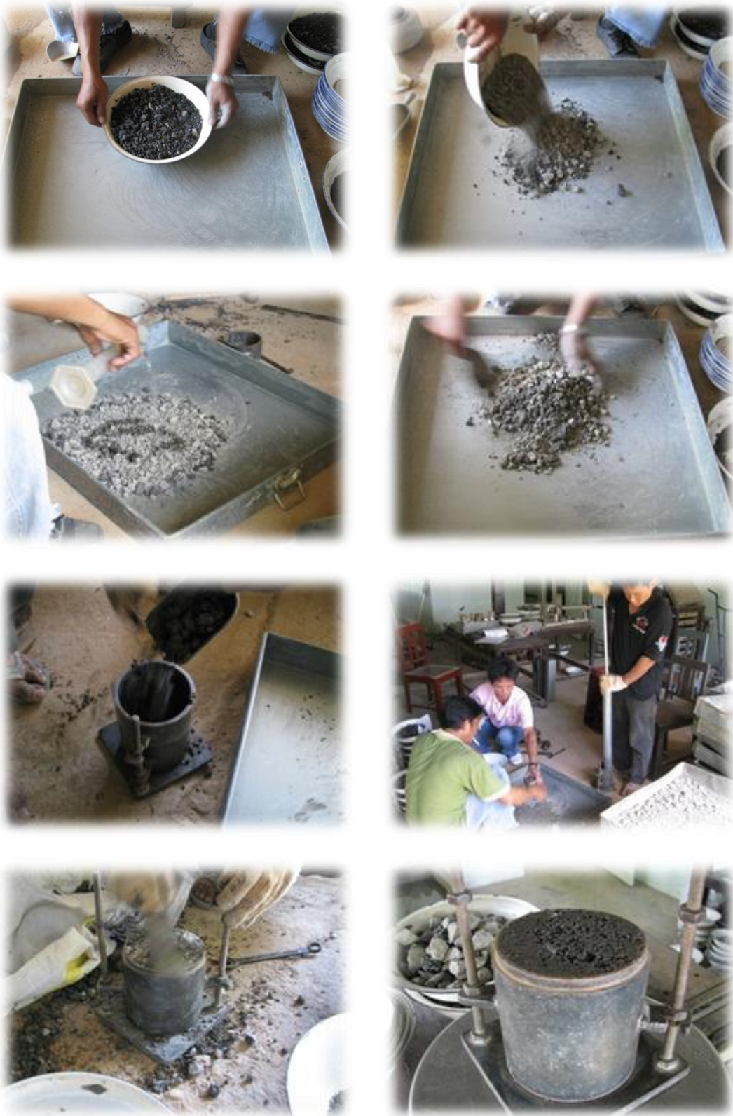
ภาพที่ 3-11 การทดลองหาค่าความหนาแน่นแห้งสูงสุด และปริมาณน้ำที่เหมาะสม
