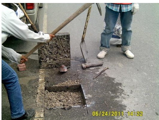
ภาพที่ 3-4 การเก็บตัวอย่างวัสดุโดยวิธี SAW
