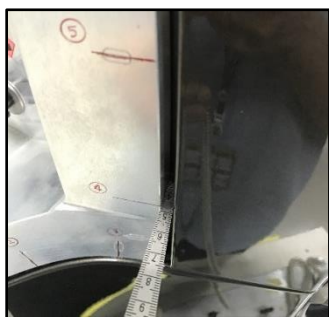
วิธีการตรวจสอบ Gap โดย Taper gauge
