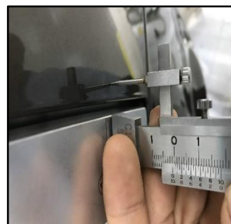
วิธีการตรวจสอบ Step ด้วย Step gauge
