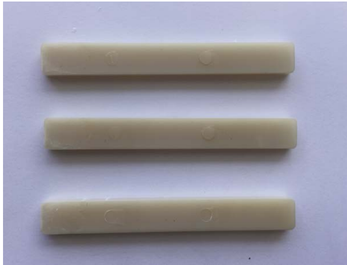
ภาพภาคผนวกที่ ข-3 ชิ้นงานตามมาตรฐาน ISO 180 รูปทรงสี่เหลี่ยมผืนผ้า ขนาดกว้าง 10 มม. ยาว 80 มม.และหนา 4 มม.
