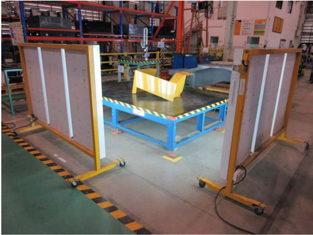
ภาพที่ 4-11 การตรวจสอบชิ้นส่วนในปัจจุบันโดยการใช้แสงไฟ 2 แฉงเพื่อทำการตรวจสอบ ชิ้นงานสามารถมองเห็นชิ้นงานได้ทั้ง 2 ด้าน (หลังการปรับปรุง)
