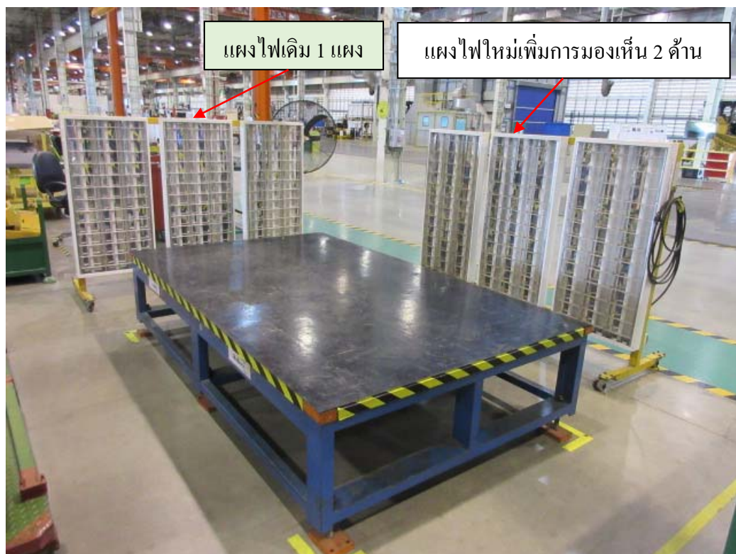
ภาพที่ 4-9 การตรวจสอบชิ้นส่วนในปัจจุบันโดยการใช้แสงไฟ 2 แฉงเพื่อทำการตรวจสอบชิ้นงาน (หลังการปรับปรุง)
