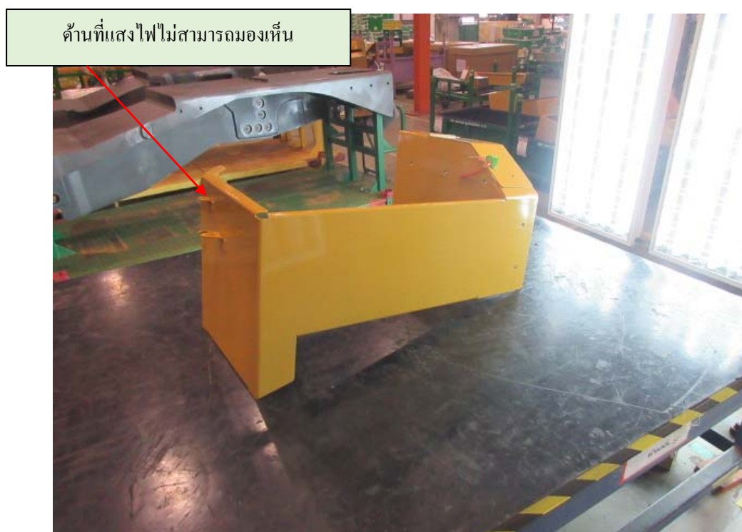
ภาพที่ 4-8 ทิศทางของแสงไฟในการเปิดแผงไฟที่ใช้ในการตรวจสอบแบบเดิมซึ่งสามารถมองเห็นเพียงด้านเดียว (ก่อนการปรับปรุง)
