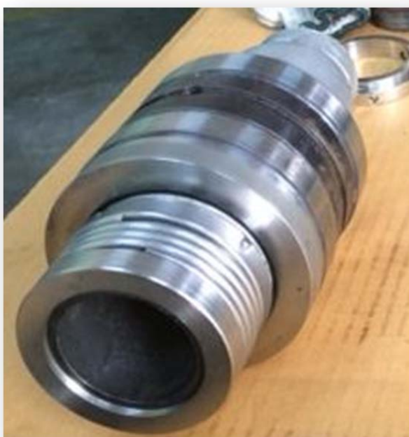
ภาพที่ 4-4 ชุด Rotary joint หลังจากการประกอบเข้ากับ Bellows assembly
