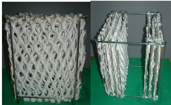
ภาพที่ 2 ลักษณะของตัวกลาง Bioweb ที่ติดตั้งในถังปฏิกรณ์เติมอากาศของระบบ IFAS
