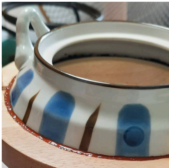
ภาพที่ 3-18: การทดลองประสานเศษเซรามิกและไม้ด้วยยางรัก
