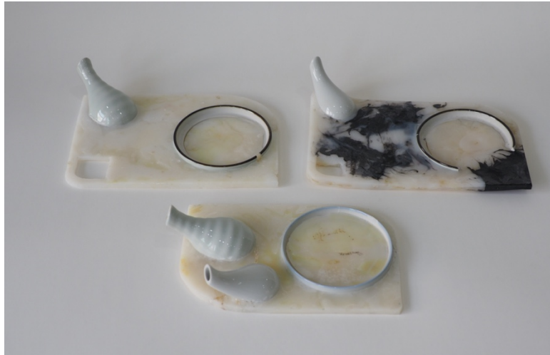
ภาพที่ 3-16: การทดลองใช้ความร้อนละลายพลาสติกเพื่อประสานระหว่าง 2 วัสดุ ที่มา: ฝนทิพย์ วรรณนะศิริินทร์ รังสิตสวัสดิ์
