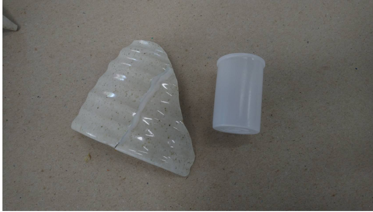
ภาพที่ 3-12: การทดลองประสานวัสดุเซรามิกด้วยพลาสติก (ชนิดที่ 2) โดยการใช้ความร้อน ที่มา: ฟนทิพย์ วรรณะศิริินทร์ รังสิตสวัสดิ์
