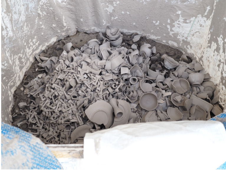
ภาพที่ 3-4: ตัวอย่างเศษเซรามิกที่เป็นของเสียจากการผลิตของ บริษัท สยาม โทซู เซรามิก จำกัด ที่มา: ฝนทิพย์ วรรณนะศิริินทร์ รังสิตสวัสดิ์
