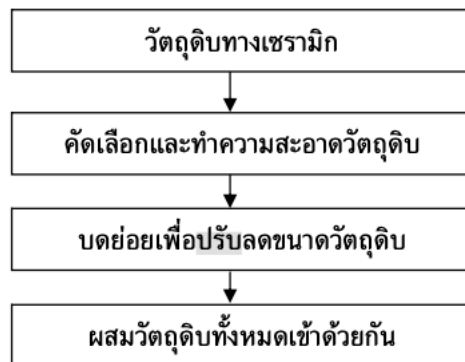
ภาพที่ 2-11: กระบวนการผลิตของอุตสาหกรรมเซรามิกกลุ่มเครื่องใช้บนโต๊ะอาหาร ที่มา: (รักเร่ เกลื่อนเมฆ, 2547)
