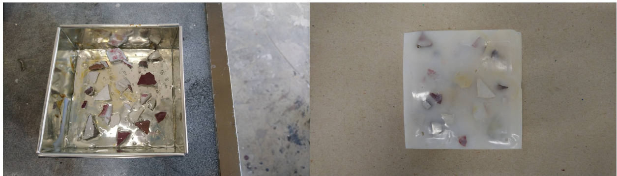
ภาพที่ 3-13: การทดลองใช้เศษเซรามิกขนาดเล็กประสานด้วยพลาสติกละลาย ที่มา: ฟนทิพย์ วรรณะศิริินทร์ รังสิตสวัสดิ์
