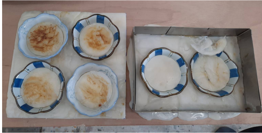
ภาพที่ 3-14: การทดลองใช้ความร้อนละลายพลาสติกเพื่อประสานระหว่าง 2 วัสดุ ที่มา: ฟนทิพย์ วรรณนะศิริินทร์ รังสิตสวัสดิ์
