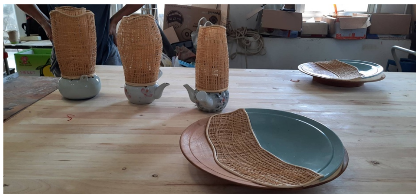
ภาพที่ 3-17: การทดลองประสานระหว่าง 2 วัสดุ ด้วยเทคนิคร้อย สาน และเชาะร่องไม้ ที่มา: ฝนทิพย์ วรรณนะศิริินทร์ รังสิตสวัสดิ์
