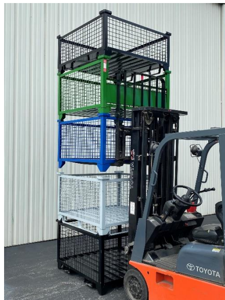
ภาพที่ 4.8 ตัวอย่าง Stackable rigid wire baskets (ที่มา; https://rackandshelf.com/ )
