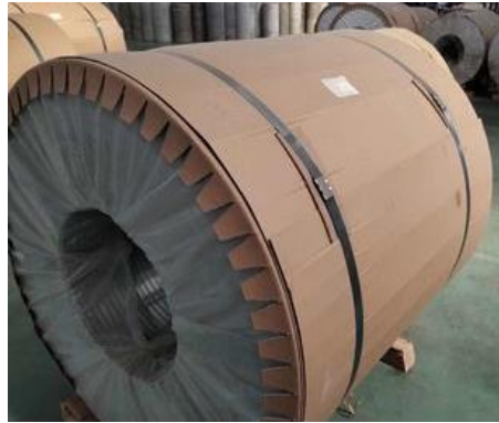
ภาพที่ 4.2 ตัวอย่าง One-way packaging ของ Aluminum coil (ที่มา: https://chinaluminium.manufacturer.globalsources.com )
