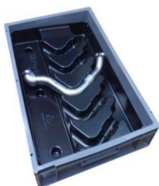
ภาพที่ 4.21 ตัวอย่าง Vacuum thermoformed dunnage ของชิ้นส่วนโลหะ (ที่มา; https://www.gwp.co.uk/ , http://www.sarveshwaripackaging.com/ )
