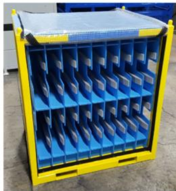
ภาพที่ 4.25 ตัวอย่าง PCORR Racks สำหรับชั้นส่วนยานยนต์ขนาดกลาง (ที่มา; https://rackandshelf.com/ )
