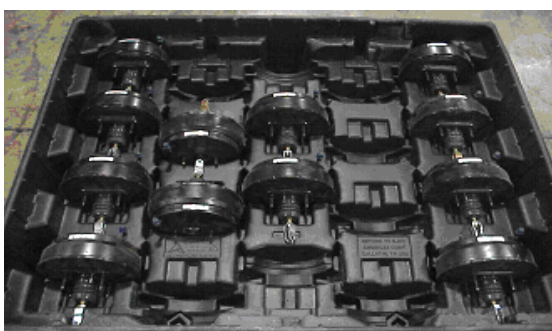
ภาพที่ 4.44 ตัวอย่าง Vacuum thermoformed dunnage (ที่มา; https://www.custommhs.com/ )
