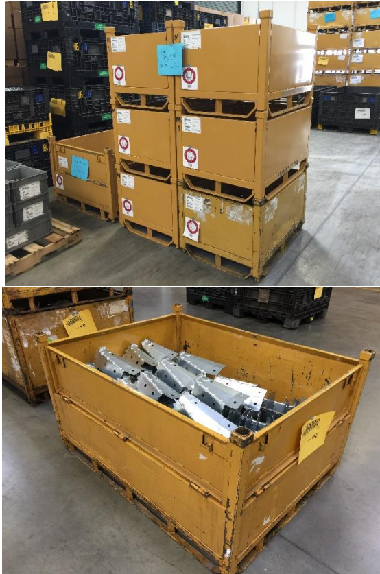
ภาพที่ 4.9 ตัวอย่าง Rigid steel containers (ที่มา; https://rackandshelf.com/ )
