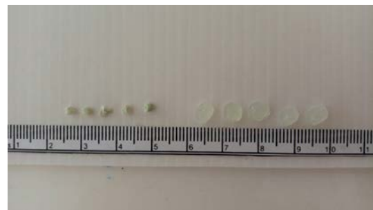
เม็ดอัลจิเนตไฮโดรเจลที่ขึ้นรูปร่วมกับซีโอไลท์ใน การขนส่งปลาหางนกยูง
