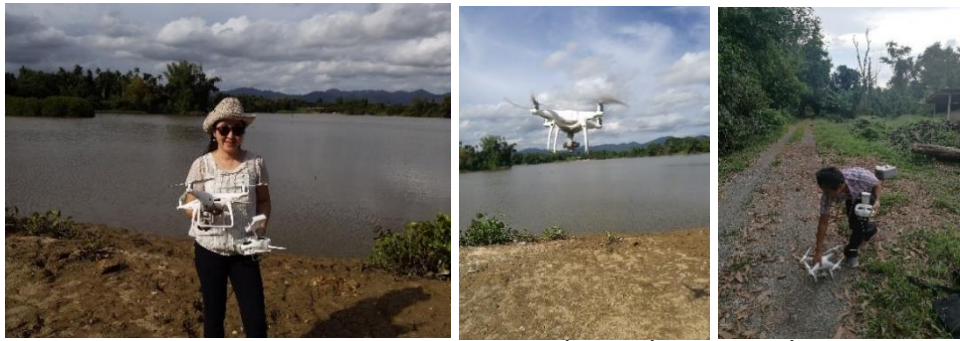
ภาพที่ 14 การเก็บข้อมูลพิกัดและพื้นที่ผิวน้ำของแหล่งน้ำโดยใช้โดรน
