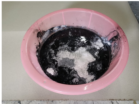
ภาพที่ 3-5 ผสมถ่านกัมมันต์กับน้ำกวนผสมให้เข้ากัน แล้วใส่ปูนปลาสเตอร์ที่หลัง
