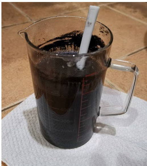
ภาพที่ 3-15 ผสมถ่านกัมมันต์ น้ำหนัก 100 กรัม กลีเซอริน 2 กรัม หัวน้ำหอม 1 กรัม กวนผสมให้เข้ากัน ตั้งพักไว้ประมาณ 3 นาที เพื่อลดปริมาณฟองอากาศก่อนเทลงแบบพิมพ์
