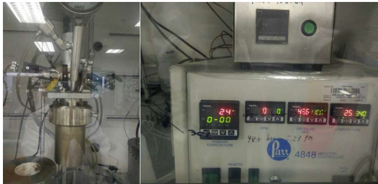
รูปที่ 2.2 รีแอกเตอร์ที่ใช้ในการผลิตกรีนไบโอดีเซล
