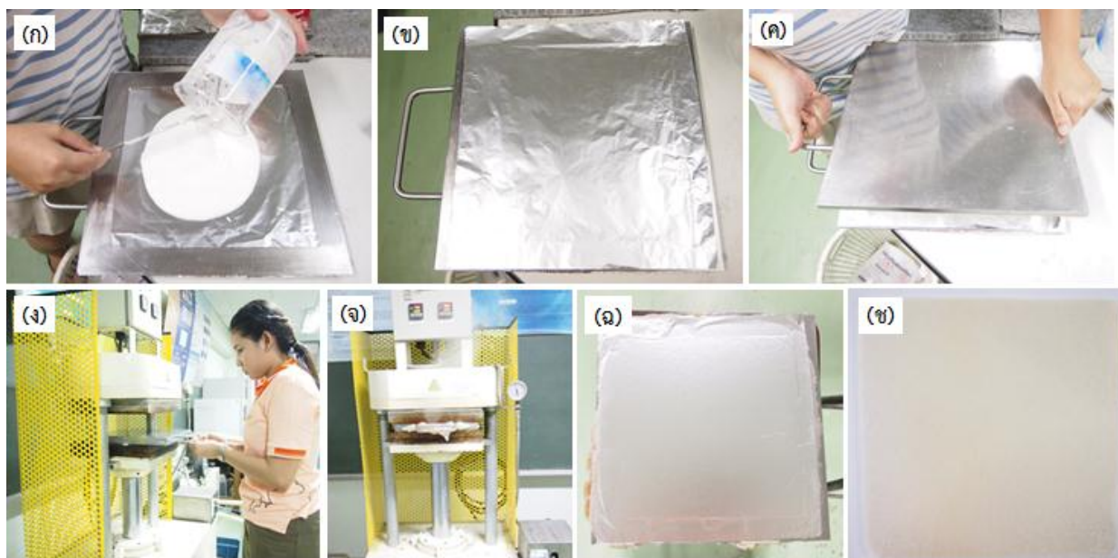
รูปที่ 3.2 ขั้นตอนการผลิตโฟม; (ก) เทของผสมลงบนแม่พิมพ์ (ข) ปิดของผสมบนแม่พิมพ์ด้วยแผ่นพอลิเอทิลีน (ค) ประกบแผ่นรองแบบด้านบนเข้าด้วยกัน (ง) ยกแม่พิมพ์เข้าสู่เครื่องขึ้นรูป (จ) ขึ้นรูปโฟมเป็นเวลา 4.50 นาที (ฉ) ตั้งแม่พิมพ์ทิ้งไว้ให้เย็นลงเป็นเวลา 5 นาที (ช) ผลิตภัณฑ์โฟมจากแป้ง
