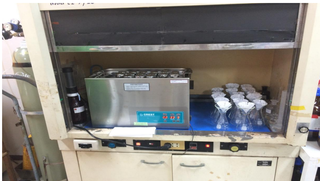
ภาพที่ 3 การสกัดสารพีเอเอชรวม ในตัวอย่างด้วยวิธี Ultrasonic
