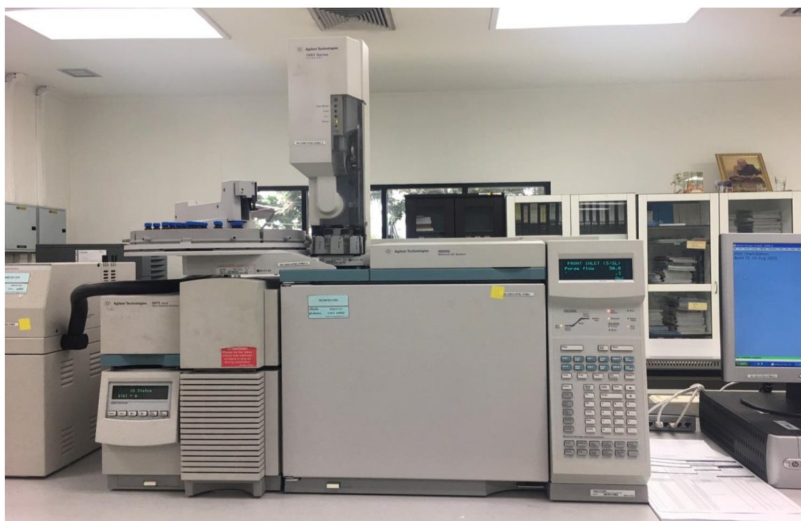
ภาพที่ 9 เครื่อง Gas Chromatograph-Mass Spectrometer (GC-MS) ของบริษัท Agilent รุ่น Agilent 6890N Gas Chromatograph/5970 inert Mass Selective Detector
