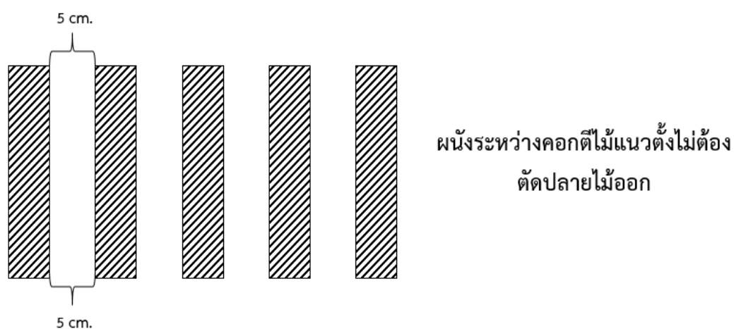
ภาพที่ 3.4 ระแนงไม้ที่ใช้ตีผนังระหว่างคอก (ตีไม้ในแนวตั้ง) ห่างกัน 5 cm.
