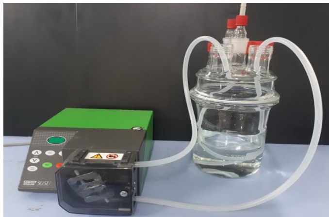
ภาพที่ 3-4 ลักษณะการจตุอุปกรณ์สำหรับการออสโมซิสเมื่อใช้ Peristaltic pump
