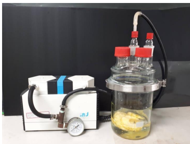
ภาพที่ 3-3 ลักษณะการจัดอุปกรณ์สำหรับการออสโมซิสด้วยเทคนิคสูญญากาศ
