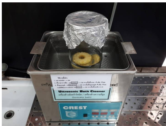
ภาพที่ 3-2 ลักษณะการจัดอุปกรณ์สำหรับการออสโมซิสด้วยเทคนิคอัลตราซาวด์
