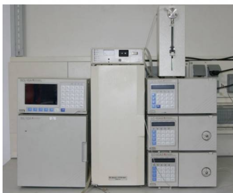
ภาพที่ 12 เครื่อง High Performance Liquid Chromatography (HPLC) (Shimadzu, Model SHIMADZU LC-10, Japan) (ที่มา: https://www.labx.com/item/shimadzu-lc-10a/LV39057579 )
