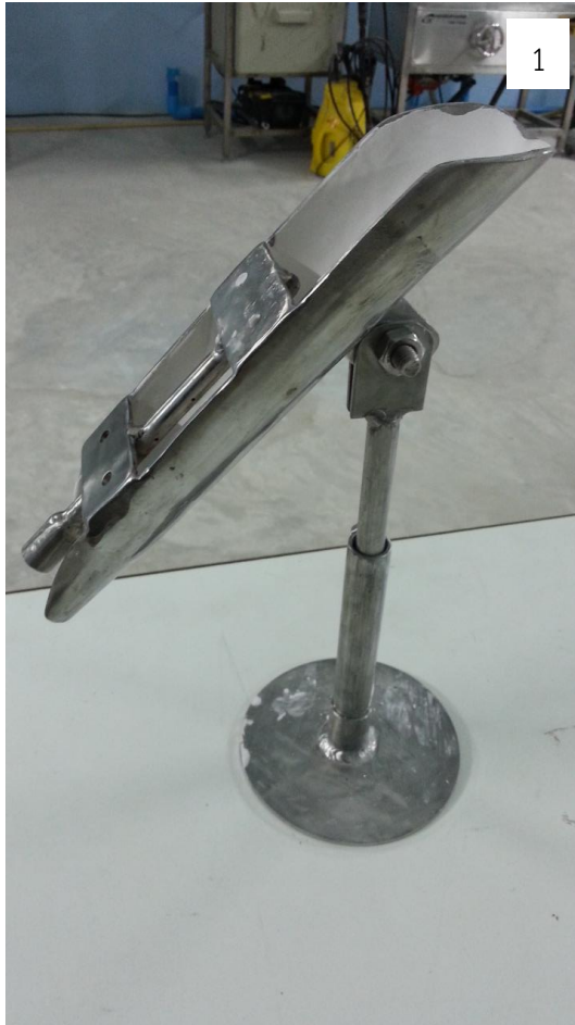
รูปที่ 4.1 ชุดรางเทหล่อโลหะกึ่งแข็ง (1) รางเท และ (2) ชุดอัดน้ำโลหะเข้าแบบหล่อ
