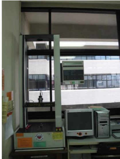
รูปที่ 3.11 เครื่องทดสอบแรงดึง รุ่น LR10K ผู้ผลิต LLOYD Instruments
