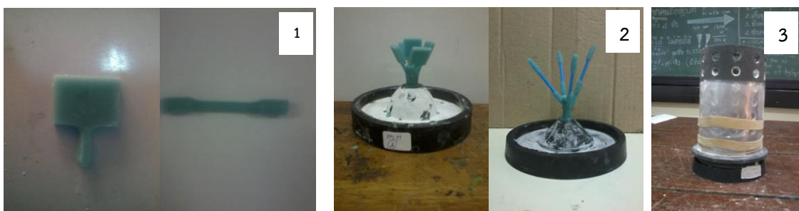
รูปที่ 3.3 การเตรียมชิ้นงาน 1) ชิ้นงาน 2) ต้นเทียน และ 3) กระบอกล่อเหล็กมาครอบต้นเทียน
