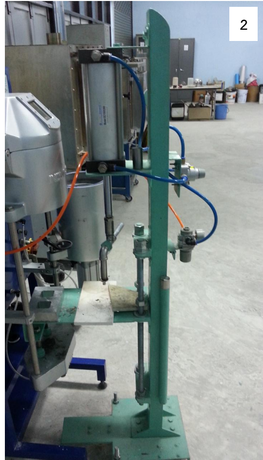
รูปที่ 4.1 ชุดรางเทหล่อโลหะกึ่งแข็ง (1) รางเท และ (2) ชุดอัดน้ำโลหะเข้าแบบหล่อ
