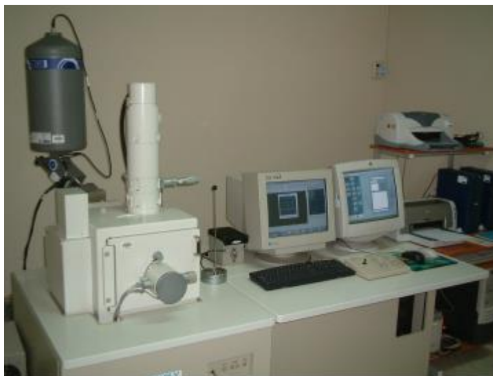
รูปที่ 3.9 กล้องอิเล็กตรอนแบบส่องกราด รุ่น JSM 5910L ผู้ผลิต Jeol Co., Ltd.
