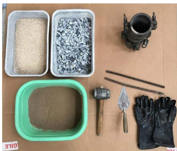
รูปที่ 3.5 ส่วนผสมที่ใช้ในการหล่อตัวอย่าง
