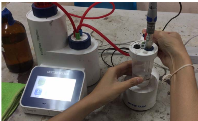
รูปที่ 3.12 การทดสอบการแทรกซึมของคลอไรด์ตามมาตรฐาน ASTM
