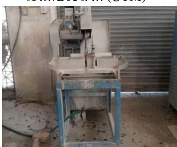
16. เครื่องตัดคอนกรีต
